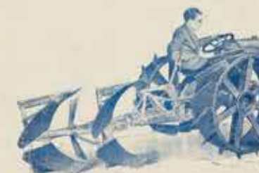
Fig. 2106 - Arado reversible PELFOR basico con y sin terreno, con enganches especiales para tractores FARMALL, FORDSON e INTERNACIONAL.
