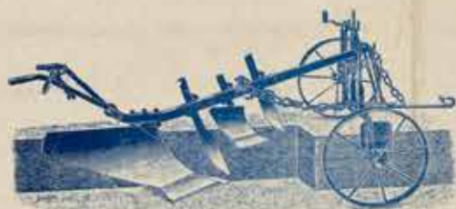
Fig. 2109 - Arado 600 para profundidades de 40 a 50 cm.
